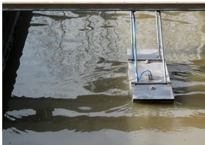
Solución patentada con flotador para detección de caudal e sedimentación
